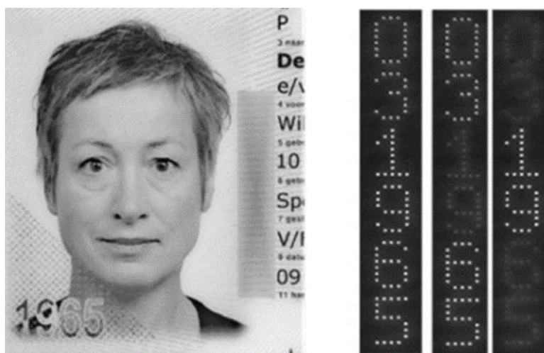
Slika 4.21 Prikaz primjene laserske perforacije s promjenjivim efektom
