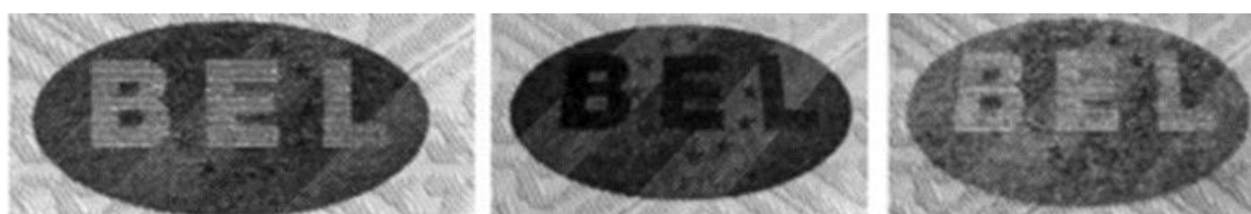
Slika 4.27 Prikaz djelovanja optički promjenjive tinte s reljefnim tiskom
