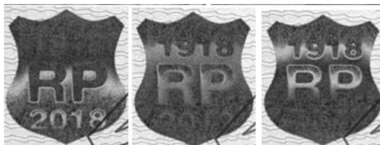
Slika 4.26 Prikaz djelovanja optički promjenjive tinte s magnetnim svojstvima
