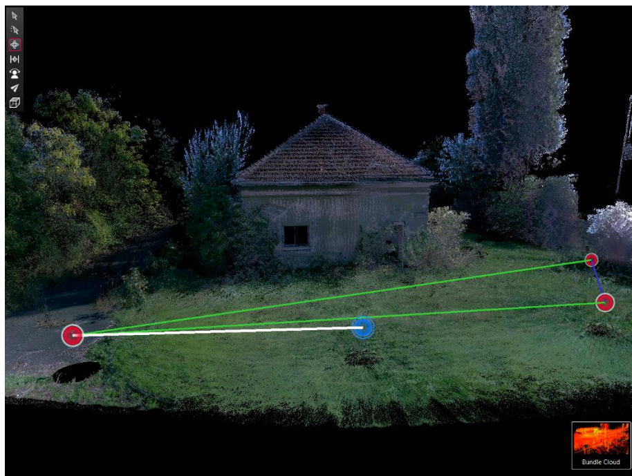
Slika 27. Prikaz pozicije skenera kod skeniranja eksterijera u softveru Leica Cyclone
