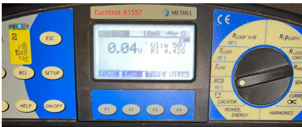
Slika 5.7. Rezultati dobiveni ispitivanjem otpora uzemljenja
