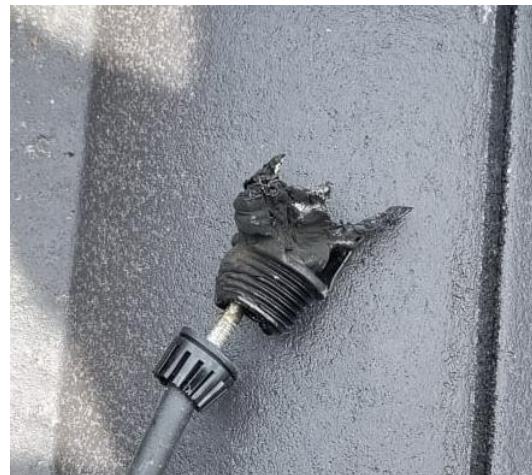
Slika 7.2. i Slika 4.3. MC4 konektor nakon izloženosti električnom luku
