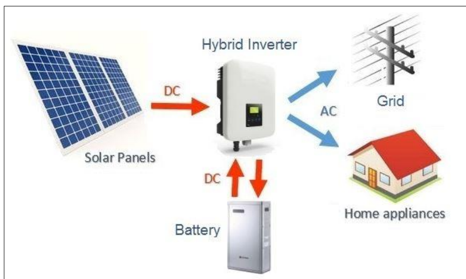
Slika 1.5. Hibridni FN sustav [9]
