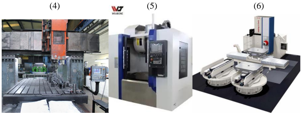
Slika 4. Portalna glodalica [14], glodaći obradni centar [13] i glodaća obradna ćelija [6]
