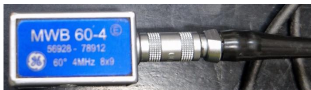
Slika 5.15 Kutna sonda MWB 60-4 [28]
