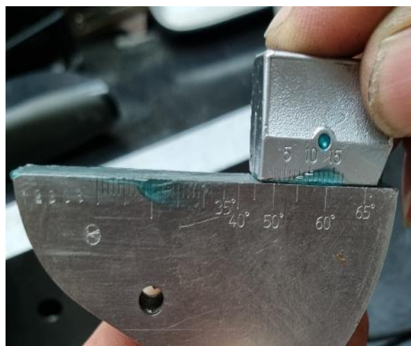
Slika 5.42 Kalibracija kuta sonde na kalibracijskom bloku V2 [28]
