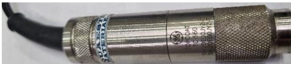
Slika 4.3 Ravna sonda sa frekvencijom 5 MHz [28]
