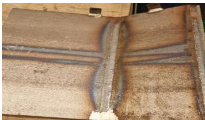
Slika 5.4 Sučeljeno X-zavaren niskouglični čelik S355 J2+N [28]
