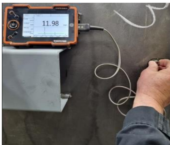
Slika 5.29 Postupak mjerenja debljine stijenke [28]
