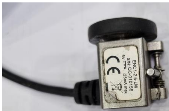
Slika 5.12 Pretvarač položaja ENC1-2.5-LM [28]
