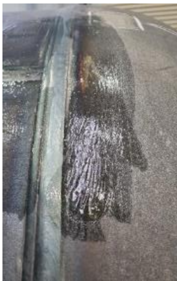
Slika 5.2 Sučeljeni V-zavar na plaštu regeneratora-izmjenjivača topline [28]
