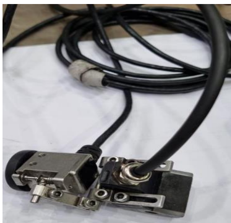
Slika 5.13 Višepretvornička sonda povezana s pretvaračem položaja spremna za ispitivanje [28]
