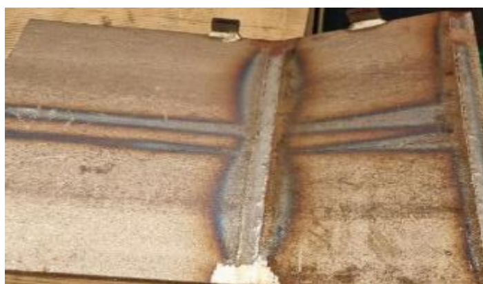
Slika 5.4 Sučeljeno X-zavaren niskouglični čelik S355 J2+N [28]
