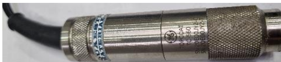
Slika 4.3 Ravna sonda sa frekvencijom 5 MHz [28]
