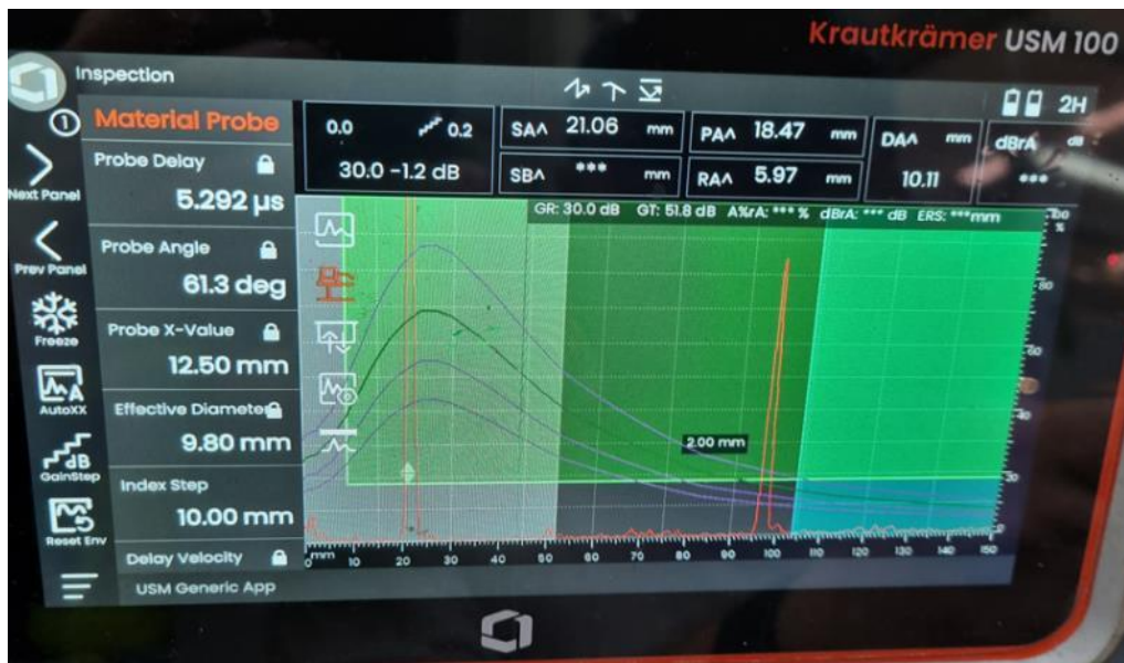
Slika 5.41 Amplituda signala kod kalibracije kutne sonde [28]
