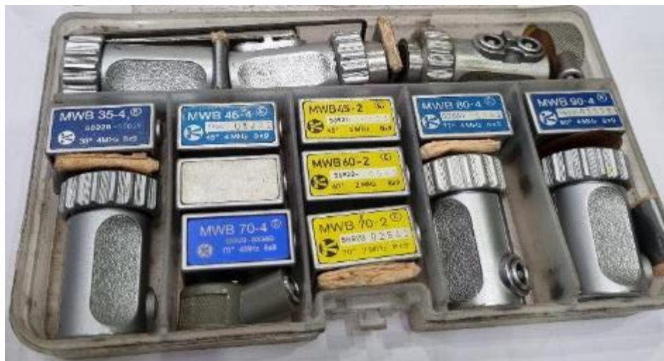
Slika 4.2 Razne vrste kutnih i ravnih sonda [28]
