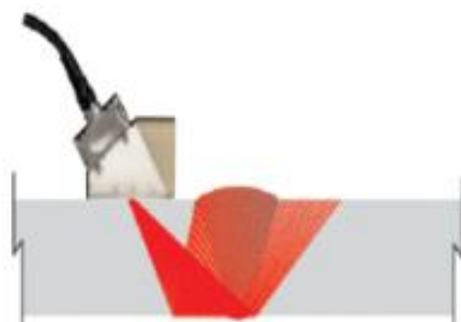
Slika 5.7 Ispitivanje višepretvorničkom sondom [20]
