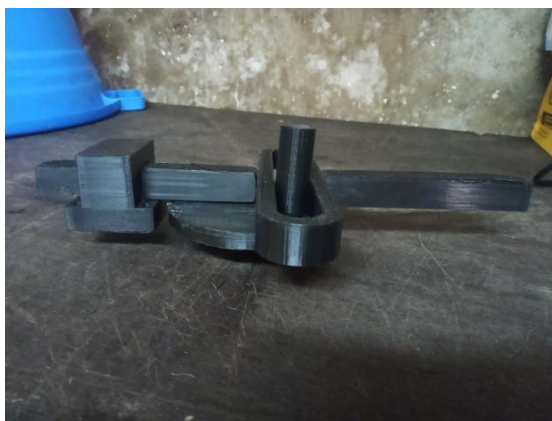
Slika 5.9.:Izgled škotskog jarma bez motora
