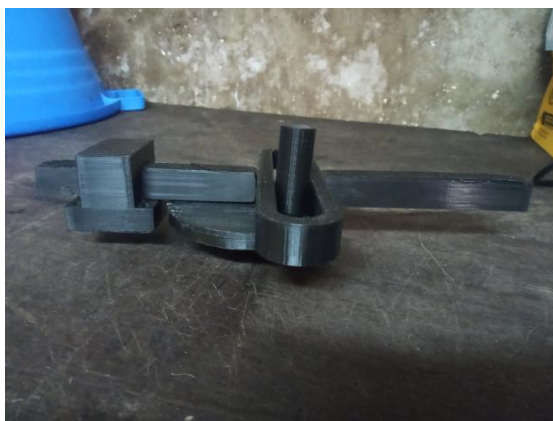
Slika 5.9.:Izgled škotskog jarma bez motora
