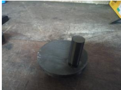
Slika 5.7.:Sklop rotacijskog dijela škotskog jarma
