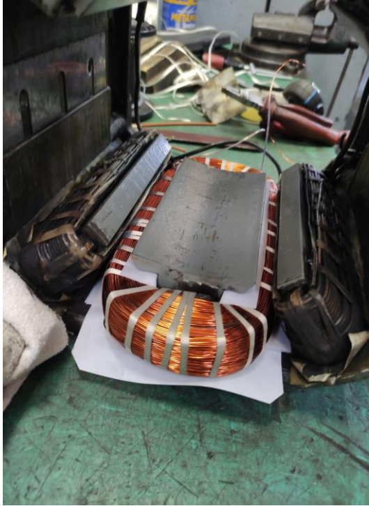
Slika 25. Namot uzbude na svojem mjestu u statoru
