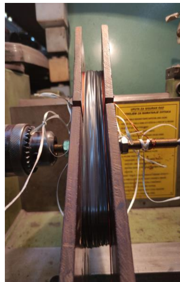
Slika 18. Stavljanje izolacijske trake na 350 zavoja (slikano u Elki 26. 6. 2024.)
