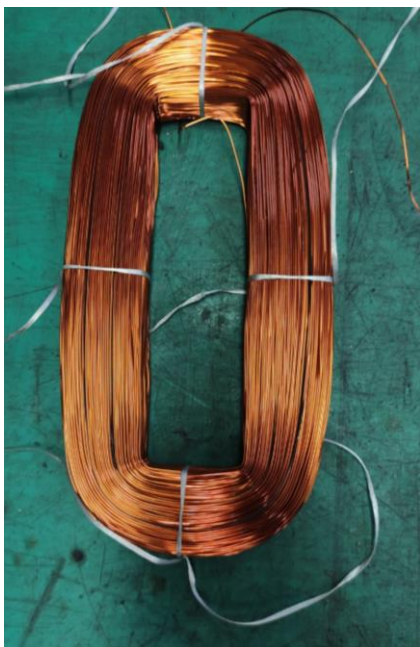
Slika 20. Uzbudni namot skinut sa sheme (slikano u Elki 26. 6. 2024.)
