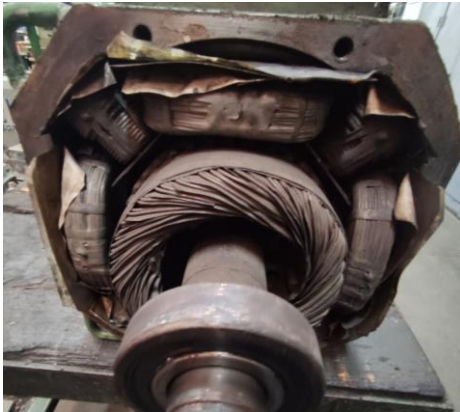
Slika 13. Rotor i stator bez kućišta (slikano u Elki 22. 4. 2024.)
