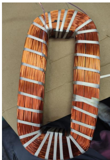
Slika 21. Uzbudni namot bandažiran trakom (slikano u Elki 26. 6. 2024.)
