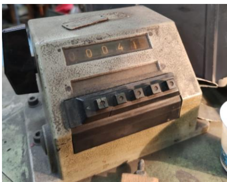
Slika 19. Brojač zavoja na prematalici (slikano u Elki 26. 6. 2024.)
