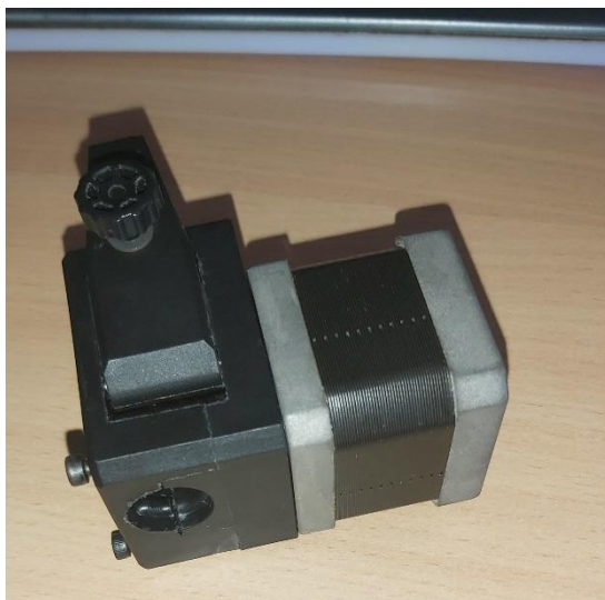
Slika 3.8 Bontech BMG ekstruder sa stepper motorom
