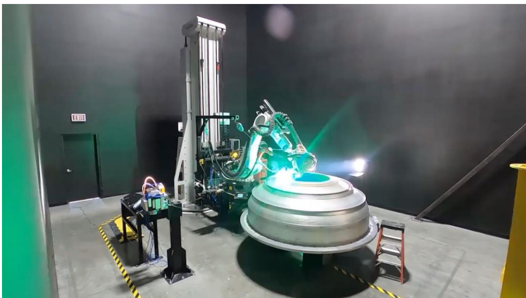
Slika 2.3 Metalno 3D ispisivanje dijelova raketa u Relativity space [3]
