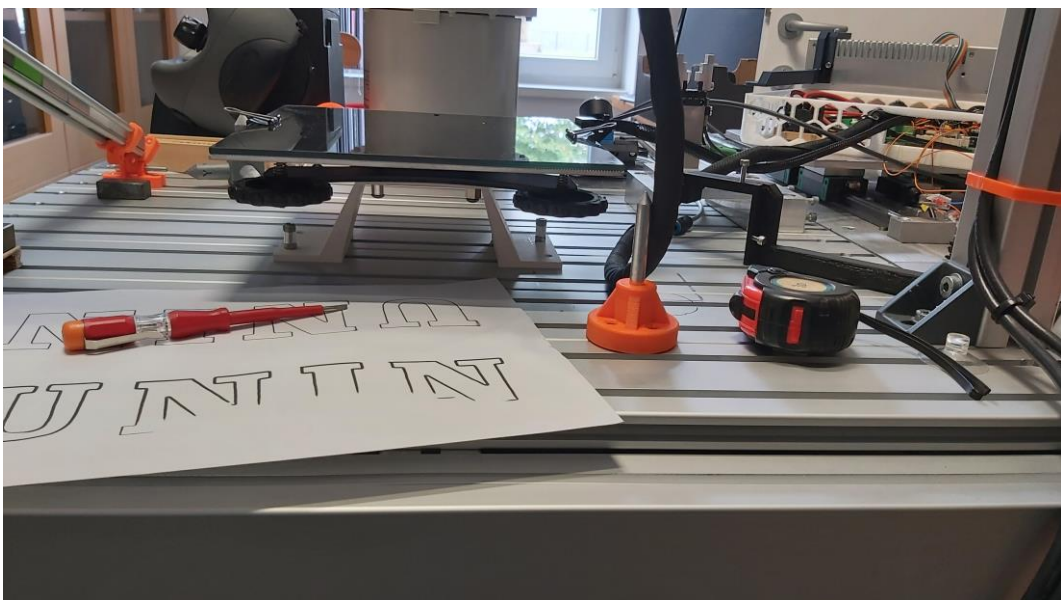
Slika 5.2 Montaža radne površine na stol
