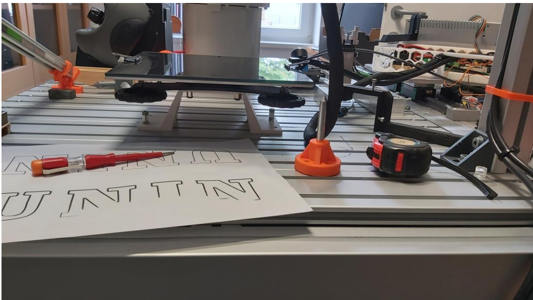
Slika 5.2 Montaža radne površine na stol
