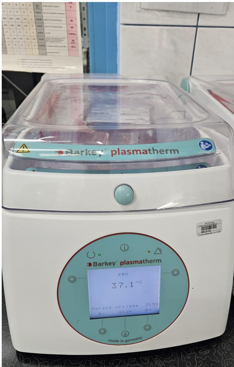
Slika 1.1.4.1.2. Postupak grijanja krvi u Barkey plasmathermu . (Izvor: Odjel za transfuzijsku medicinu ŽB Čakovec)
