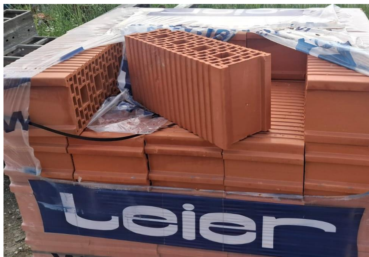
Slika 28. - Blok opeka - LEIERTHERM CL 19 U+Z 500/190/190
