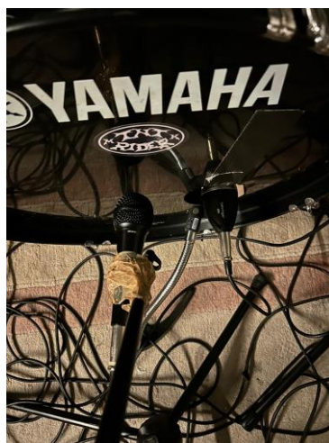
Slika 24 Postavljanje mikrofona za bas bubanj
