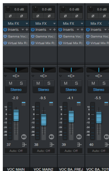
Slika 49 Bus kanali vokala
