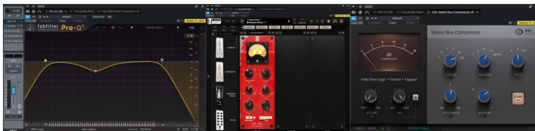
Slika 45 VST dodaci na bus kanalu bas gitare
