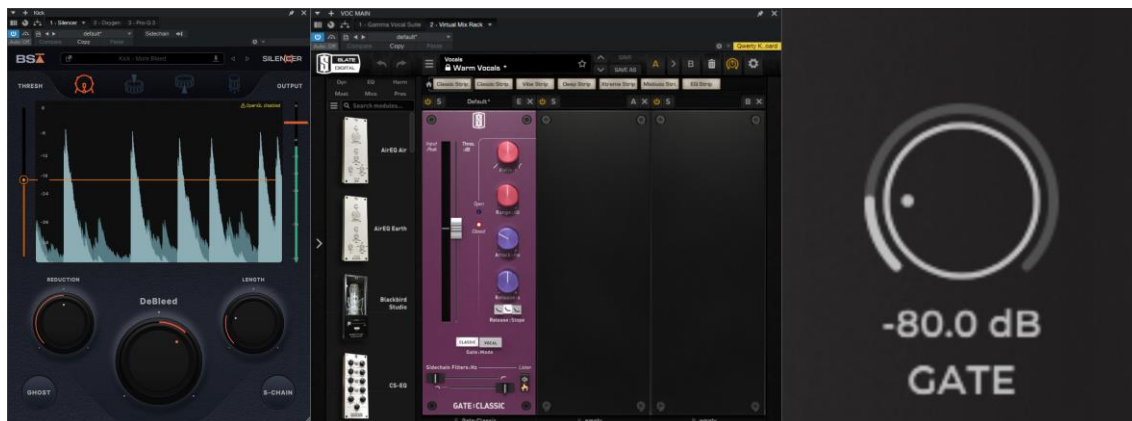
Slika 36 Gate i Noise gate VST
