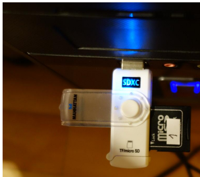
Slika 4.1 Priključen čitač SD kartice
