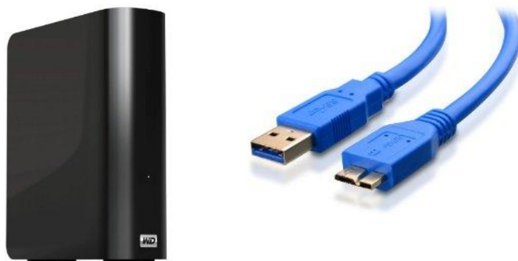
Slika 2.5 USB disk i micro USB 3.0 kabel
