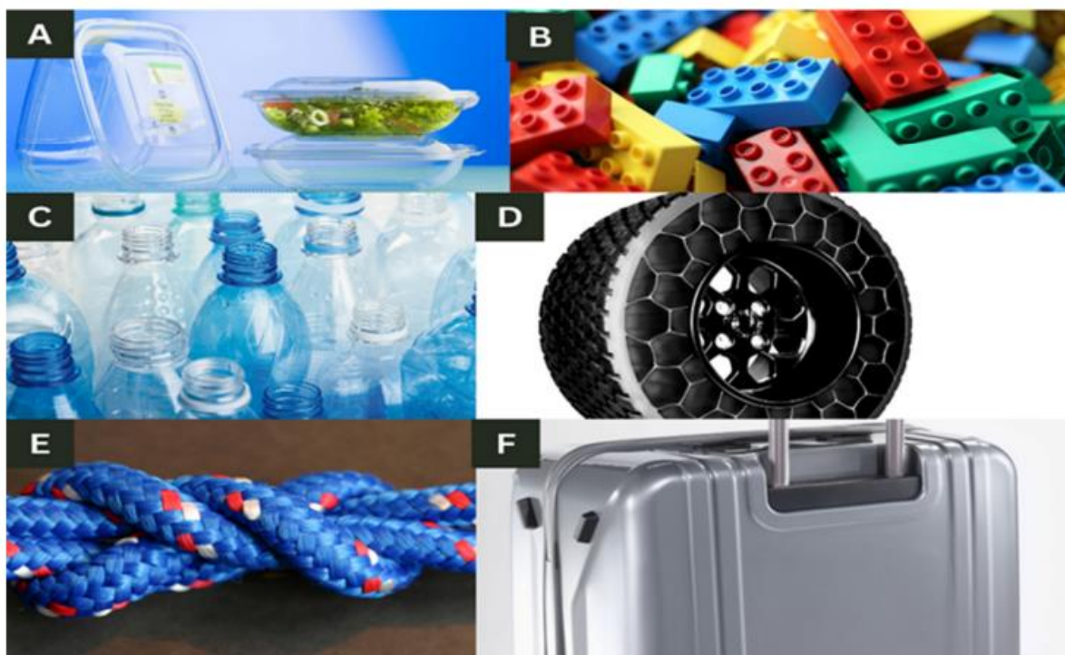
Slika 7: Različite vrste polimernih materijala dobivenih od (A) polimilječne kiseline (PLA) - spremnici za hranu; (B) akrilonitril butadien stiren (ABS) – Lego kocke; (C) polietilen tereftalat (PET) – boce s vodom; (D) termoplastični elastomeri (TPE) – bezračne gume; (E) poliamid (PA) ili najlon-uže; (F) polikarbonat (PC) – kofer na kotrljanje
