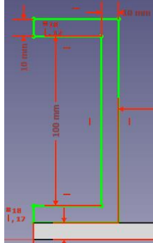
Slika 3.16 Skica U nosača valjaka
