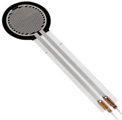
Slika2.5. - FSR-402 senzor sile [9]
