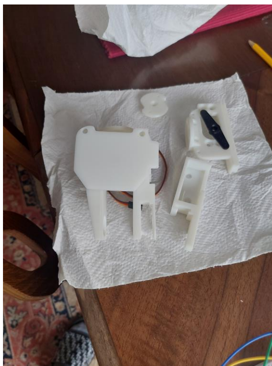
Slika 4.2.-3D isprintana linearna hvataljka
