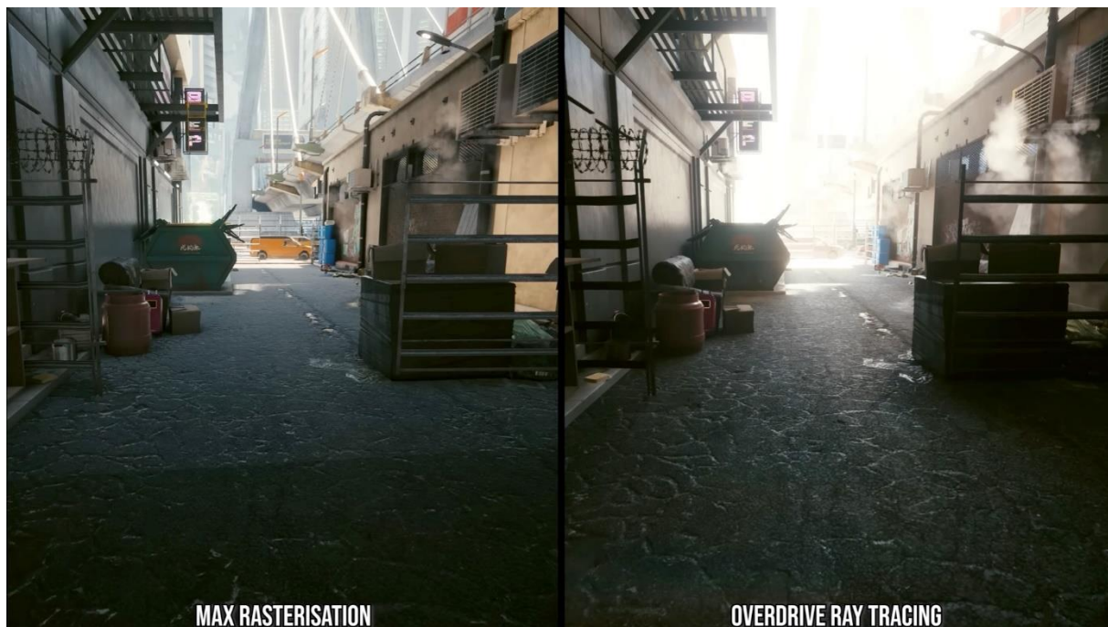
Slika 14 Usporedba rasterizacije i Ray Tracing-a
