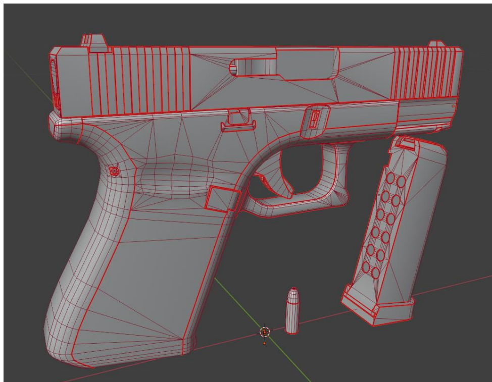
Slika 8 Šavovi na modelu prije UV mapiranja
