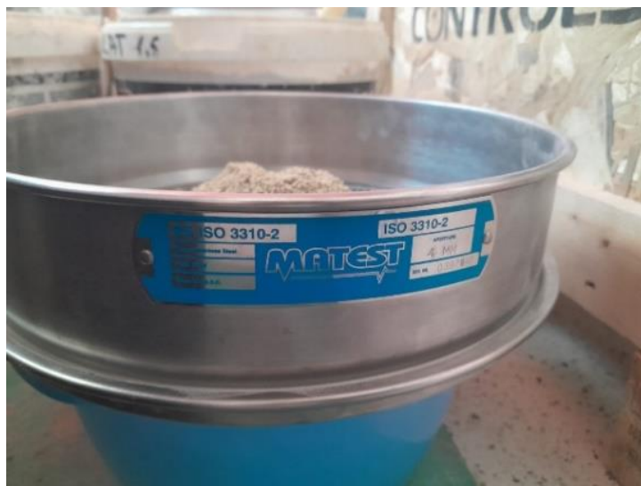
Slika 4.1 Prosijavanje pepela kroz sito otvora 1 mm
