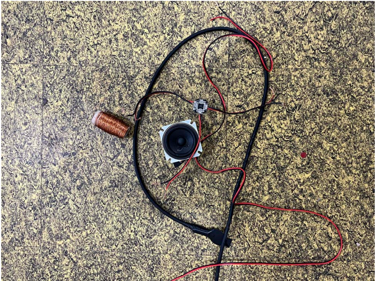
Slika 28: Materijali korišteni u instalaciji (zavojnica, mikrofon, zvučnik i digitalni modul), vlastiti izvor
