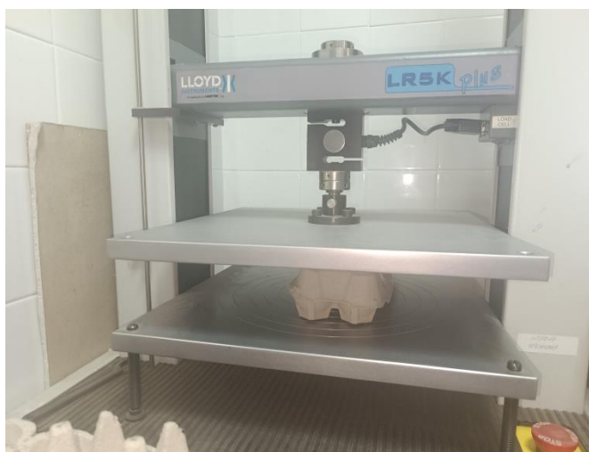
Slika 16. Uređaj za ispitivanje čvrstoće Lloyd LR5K
