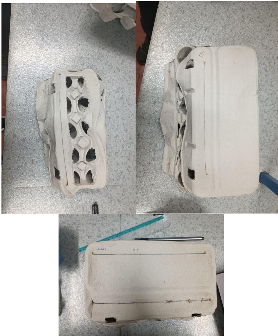
Slika 14. Deformirani podložak, podlošci s odgovarajućim postotkom utezanja
