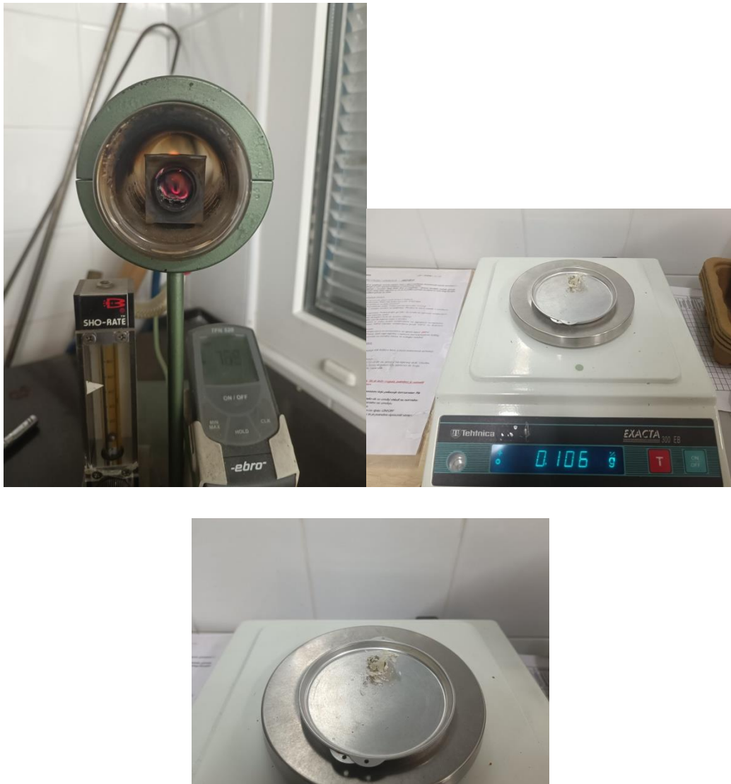
Slika 11. Peć za spaljivanje, digitalna vaga za mjerenje, ostatak nakon spaljivanja (pepeo)
