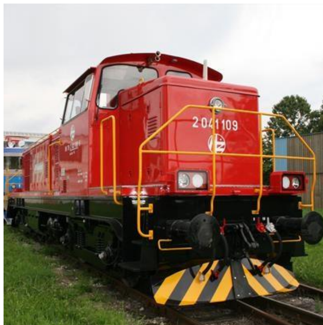
Slika 12. Dizel vučno vozilo serije 2041-100
