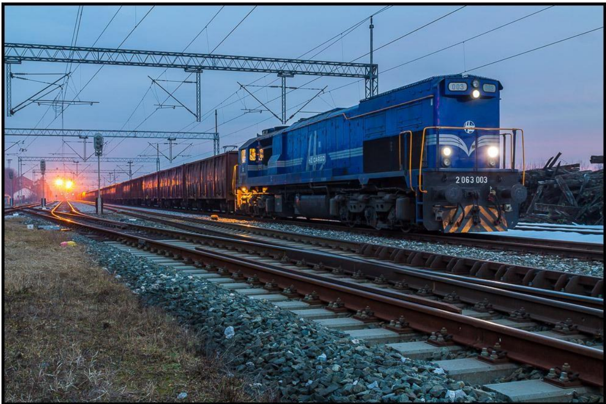
Slika 15. Dizel električno vozilo serije 2063
