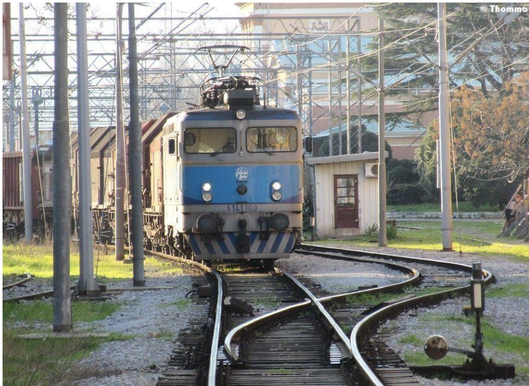
Slika 6. Elektro vučno vozilo serije 1141-100
