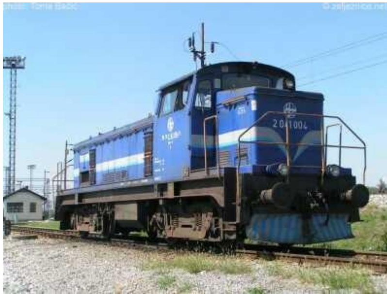
Slika 11. Dizel vučno vozilo serije 2041
