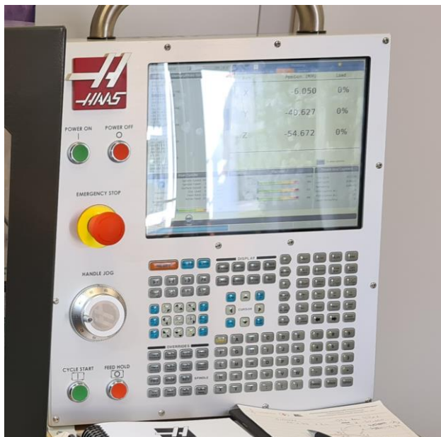
Slika 20. Upravljačka jedinica HAAS stroja [18]
