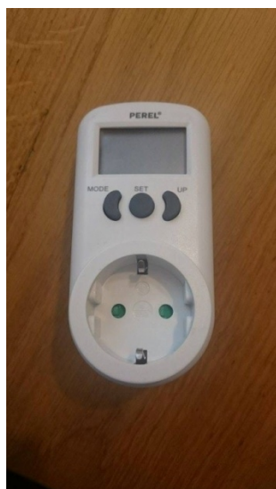
Slika 52: Mjerač potrošnje struje
