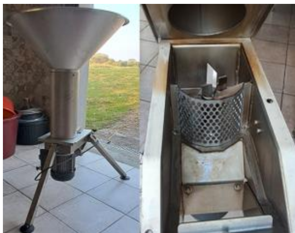
Slika 5: Mlin za mrvljenje jabuka
