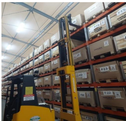
Slika 9. Način komisioniranja „čovjek k robi“
