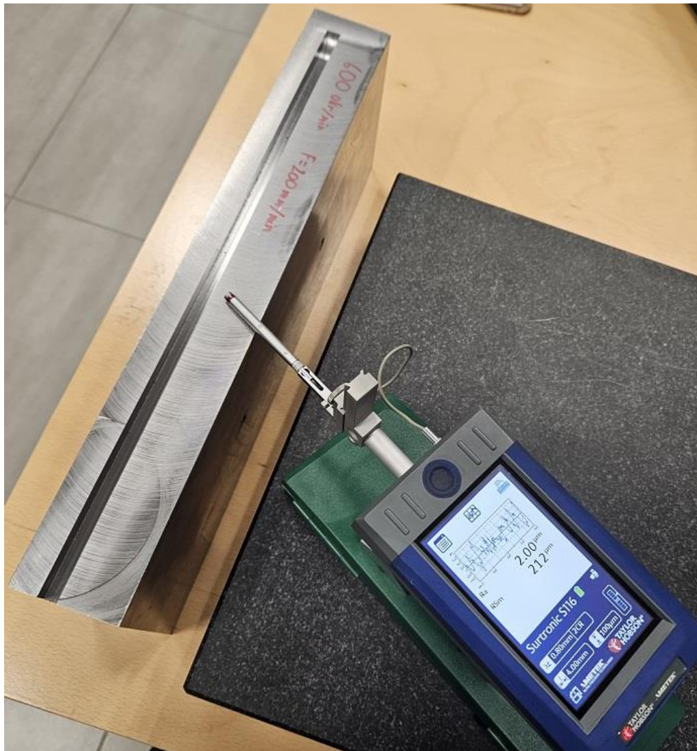
Slika 47: Mjerenje hrapavosti na bočnoj površini baze [osobne slike]
