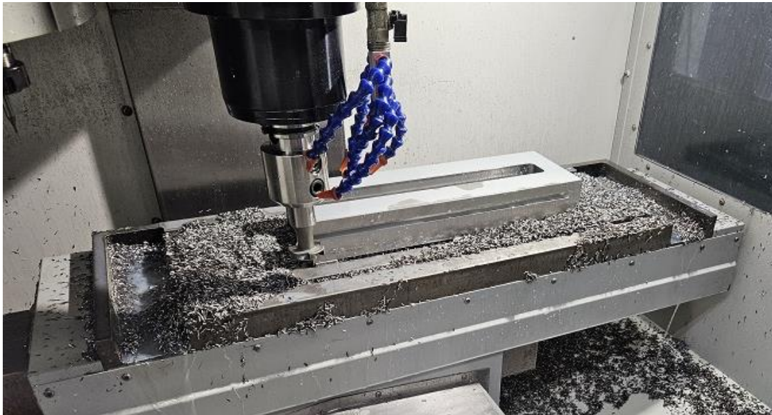
Slika 33: Glodanje sa T glodalom - 2. stezanje [osobne slike]
