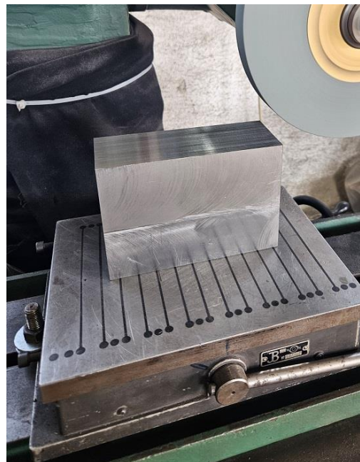
Slika 24: Obradak stegnut na magnetnoj stezaljki [osobne slike]
