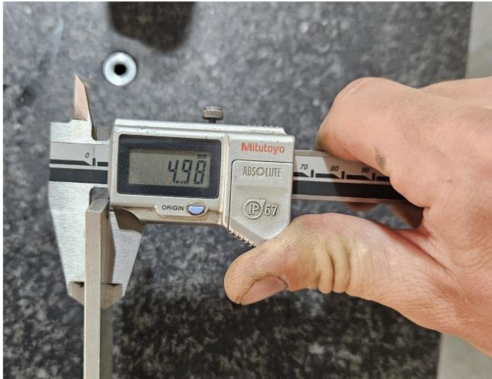
Slika 16: Mjerenje sa pomičnim mjerilom[osobne slike]
