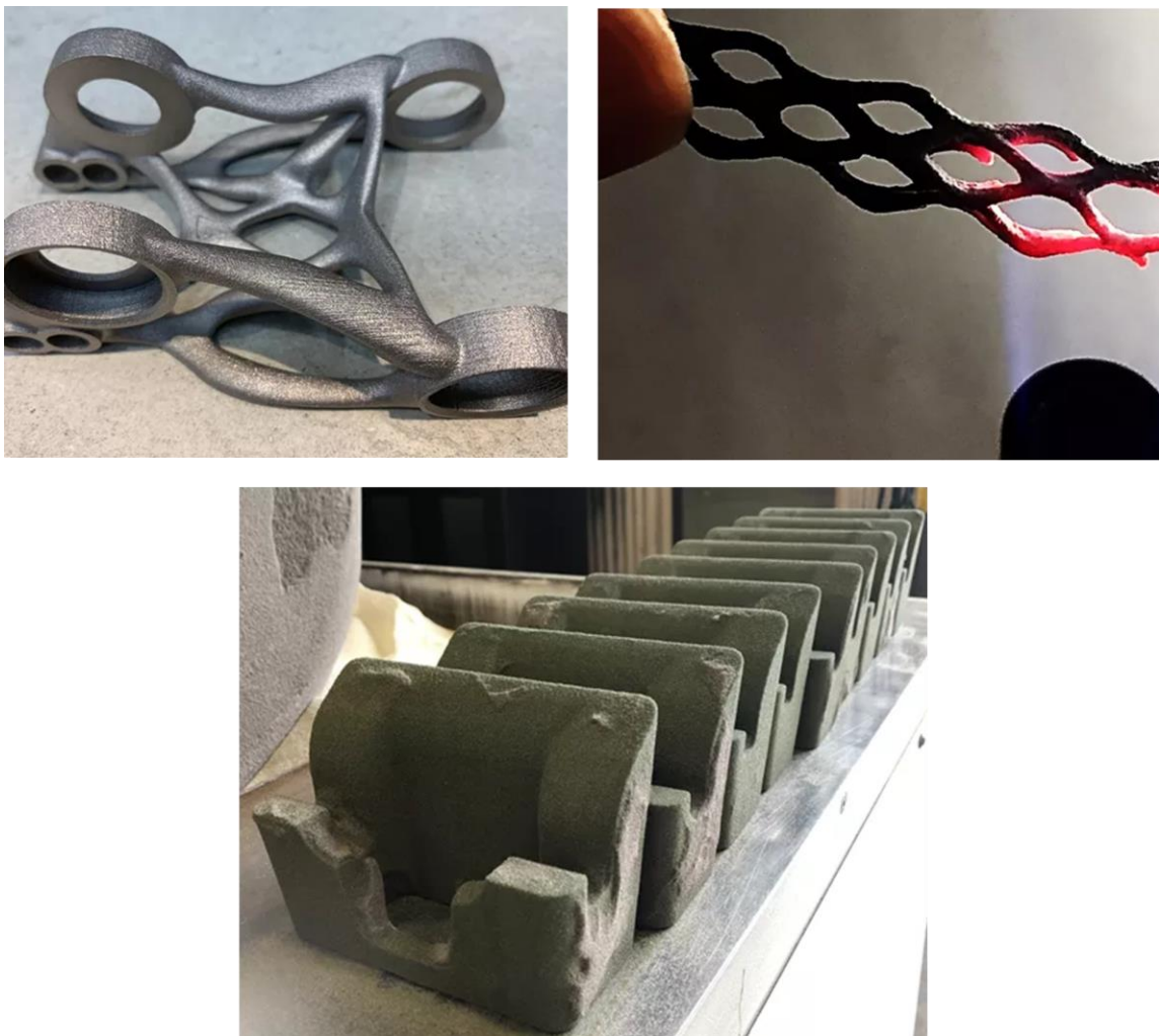
Slika 2 Predmeti od različitih materijala izrađeni aditivnim postupcima [4]
