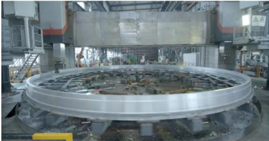
Slika 28 Spojni prsten rakete [30]
