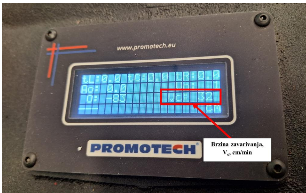
Slika 42 Namještanje brzine zavarivanja
