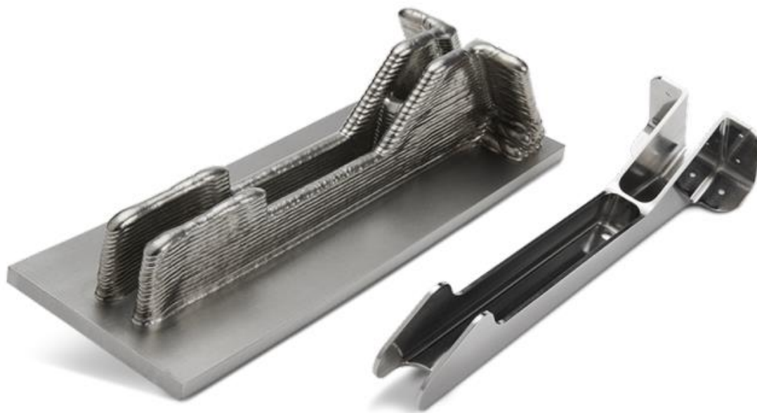
Slika 27 Komponenta zrakoplova 787 Dreamliner izrađena WAAM postupkom [29]
