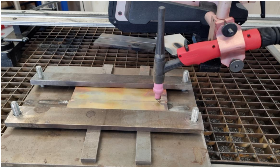
Slika 6.5. Položaj pištolja za zavarivanje – pozicija 1 [27]
