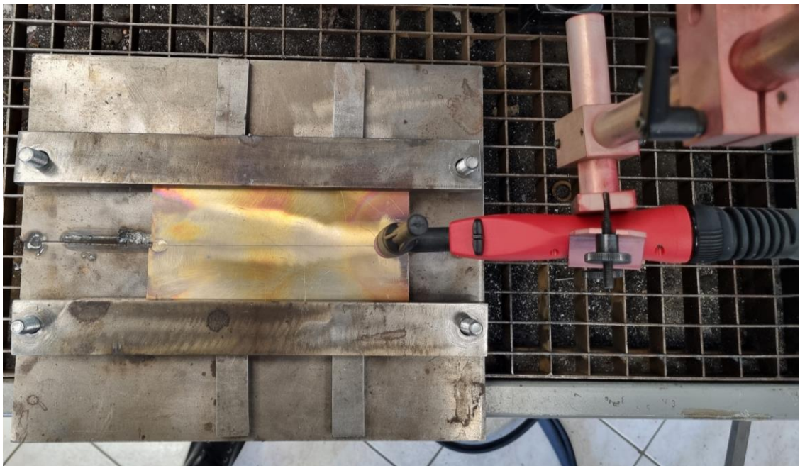
Slika 6.6. Položaj pištolja za zavarivanje – pozicija 2 [27]
