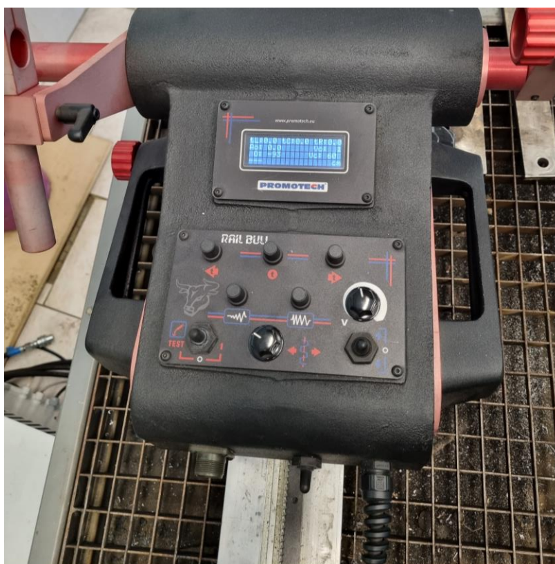
Slika 6.4. Uređaj za automatizirano zavarivanje – RAIL BULL [27]
