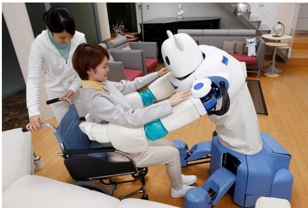
Slika 4. Prikaz robota „Robear“ pri premještanju pacijentice s kauča u kolica.
