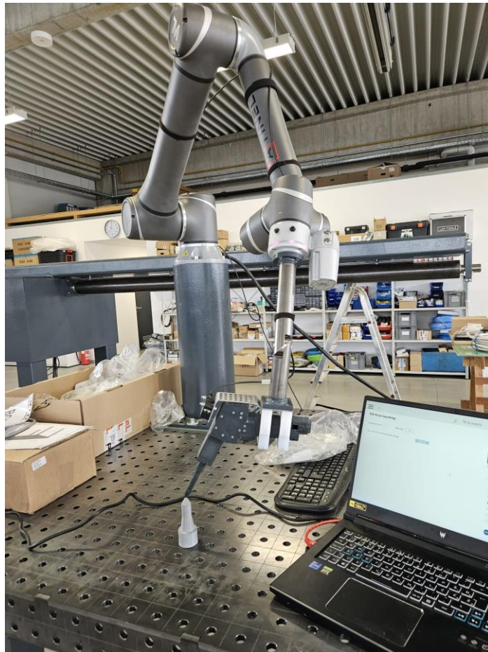
Slika 6.34 Umjeravanje TCP-a direktnom metodom 3 točke [21]
