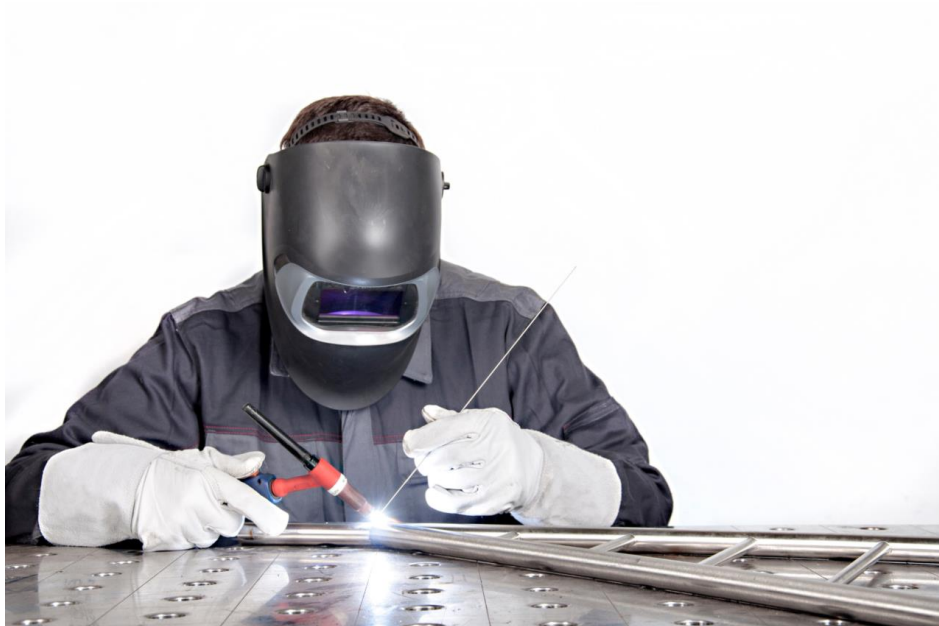
Slika 2.2.1 Ručno TIG zavarivanje [7]
