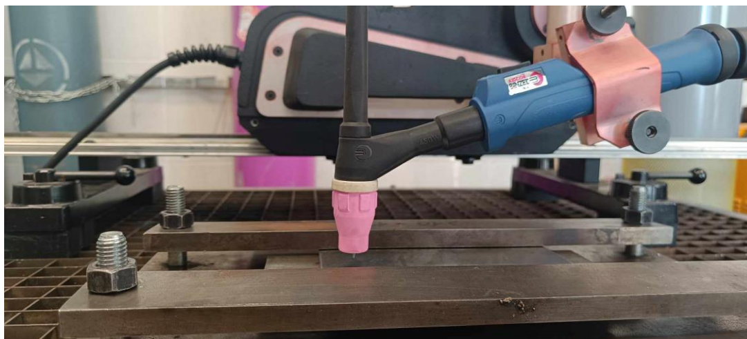
Slika 6.6.1. Pozicioniran uzorak prije zavarivanja
