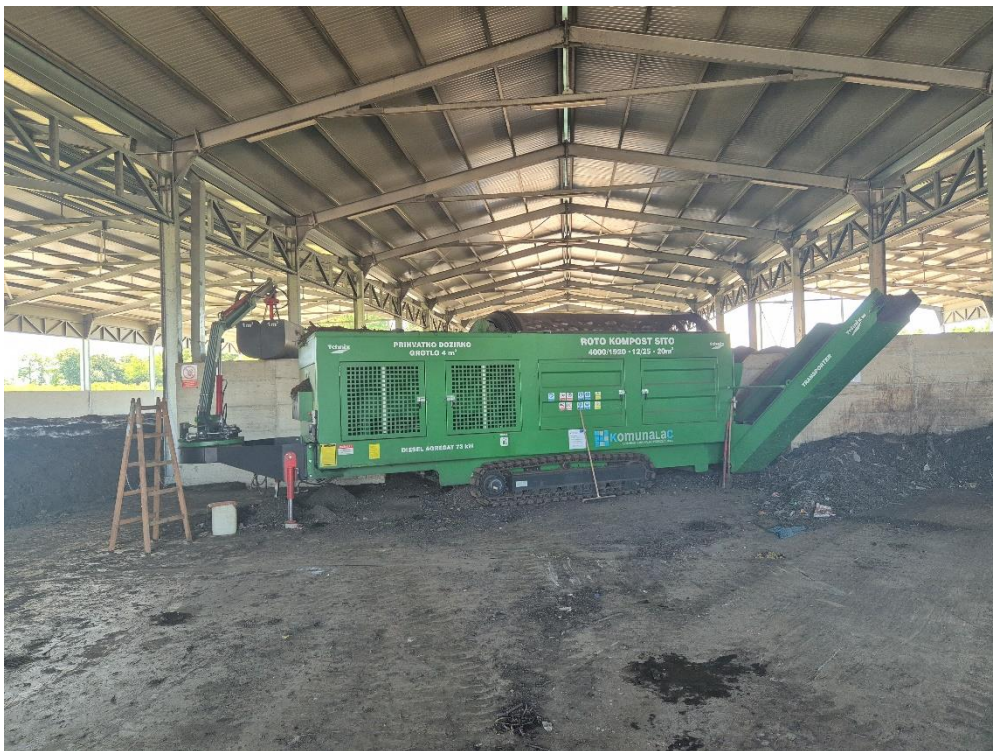
Slika 24. Stroj za prosijavanje kompostnih hrpa
