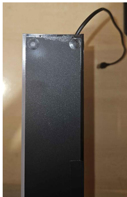
Slika 9.2.10 Donji dio instalacije sa ublaživačima
