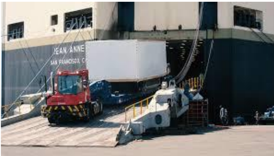
Slika 13. Primjer Ro-Ro tehnologije
