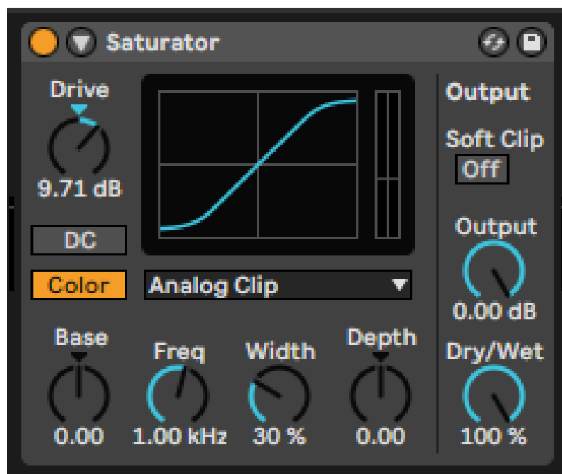
Slika 7 primjer plugina za distorziju
