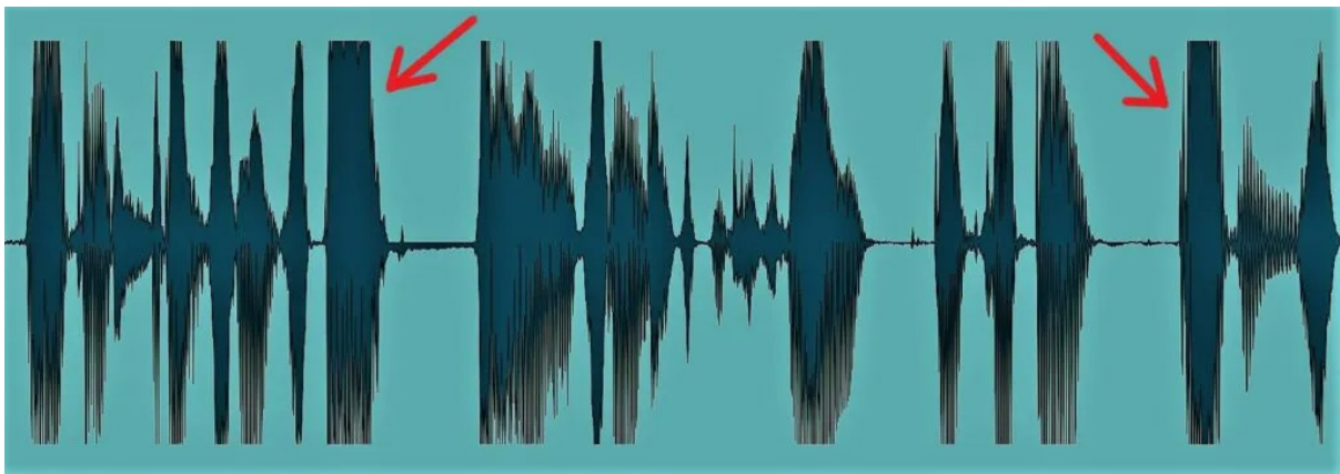
Slika 6 pojava clippinga na označenim dijelovima signala
