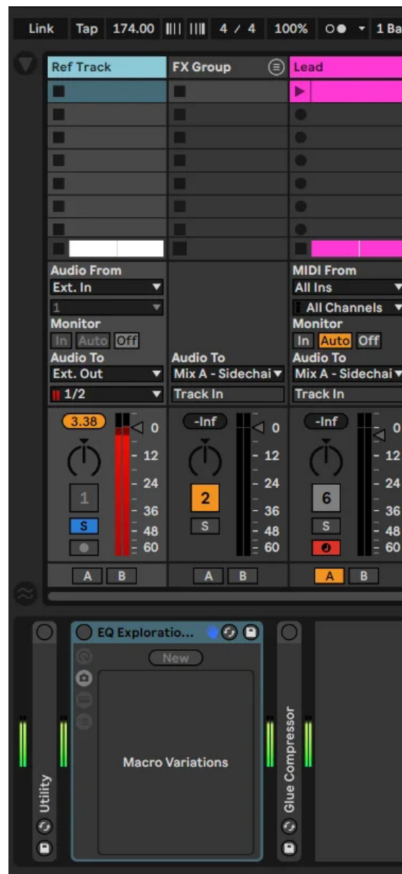
Slika 5 zvuk „ulazi u crveno” što ukazuje na pojavu distorzije
