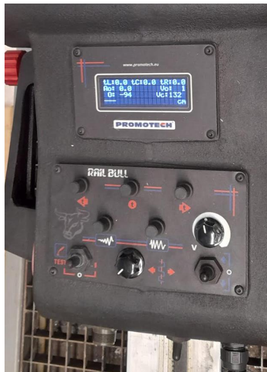
Slika 61 Sučelje uređaja za automatizirano vođenje TIG pištolj, slika je autorovo djelo.
