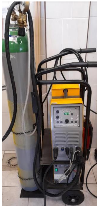
Slika 58 Uređaj za TIG zavarivanje, Vartig 2005 AC/DC [18].
