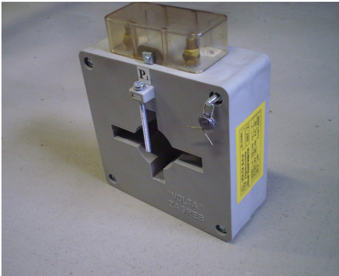
Slika 4.9 Strujni mjerni transformator prijenosnog omjera 400/5A
