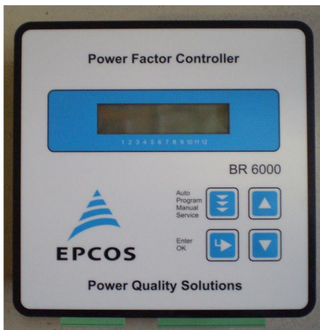
Slika 4.7 Stražnja i prednja strana regulatora faktora snage EPCOS BR6000-R6
