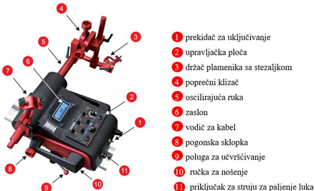
Slika 27: Uređaj za vođenje gorionika tijekom zavarivanja [34]
