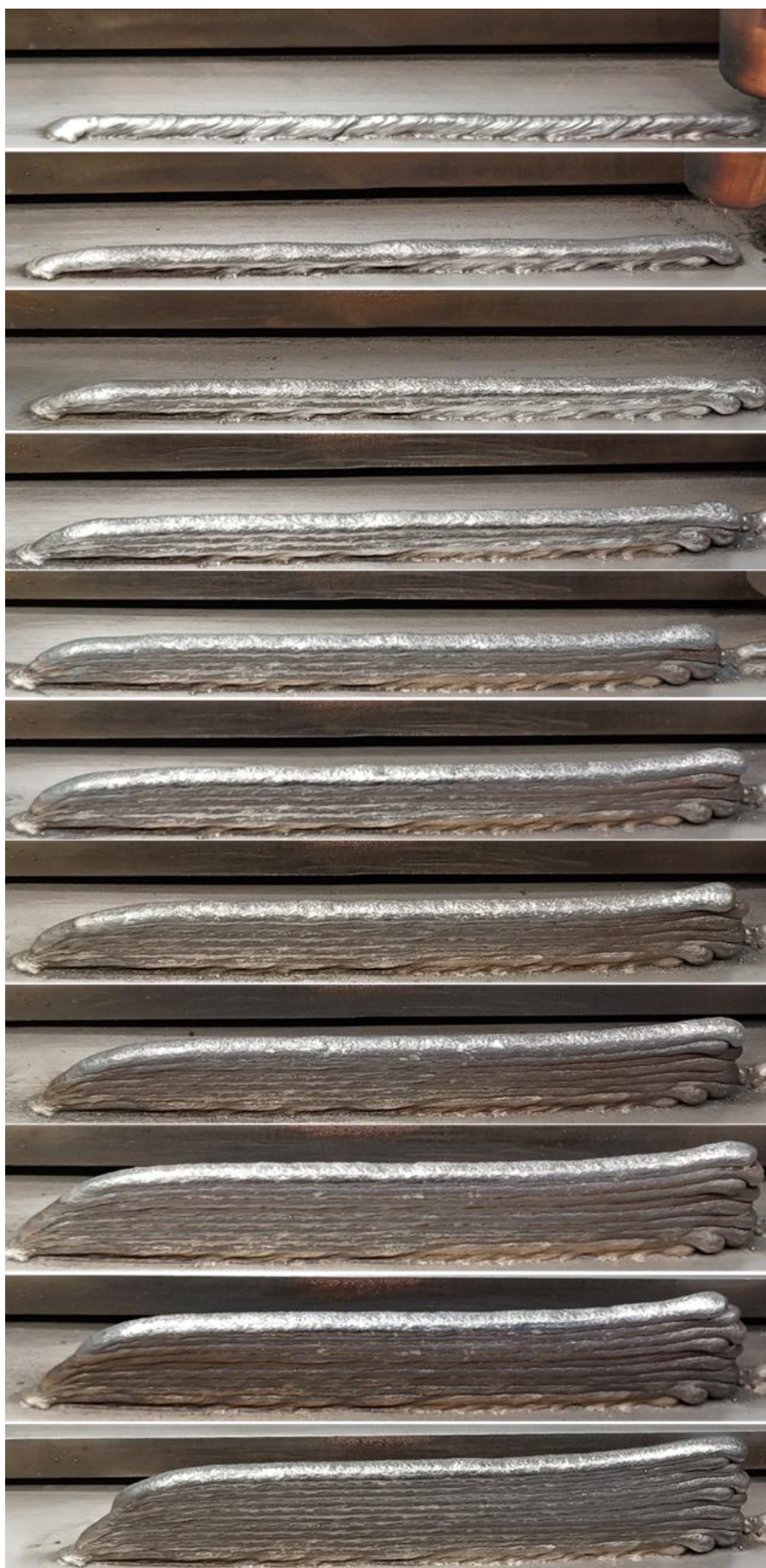
Slika 31: Proces navarivanja Zida 1 sloj po sloj
