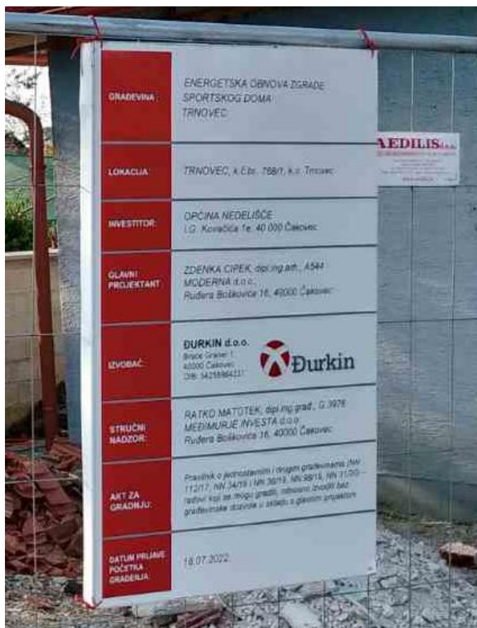
Slika 10. Primjer izgleda i sadržaja Gradilišne ploče.
