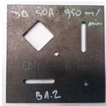
Slika 4.3.20. Uzorak B4.2 debljine 6 mm s podacima o rezanju
