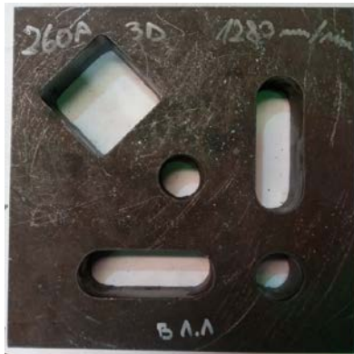
Slika 4.3.52. Uzorak B10.1 debljine 30 mm s podacima o rezanju
