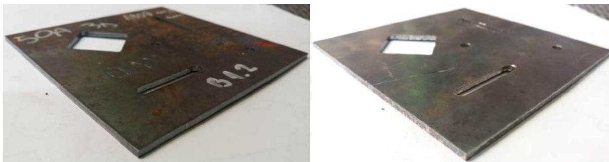
Slika 4.3.9. Uzorak B1.2 debljine 3 mm slikan s gornje i donje strane
