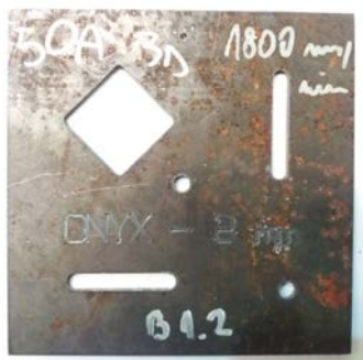
Slika 4.3.8. Uzorak B1.2 debljine 3 mm s podacima o rezanju
