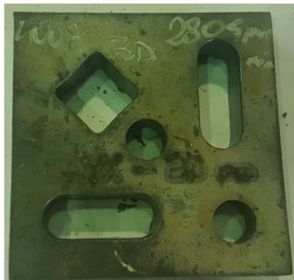
Slika 4.3.44. Uzorak B8.4 debljine 20 mm s podacima o rezanju
