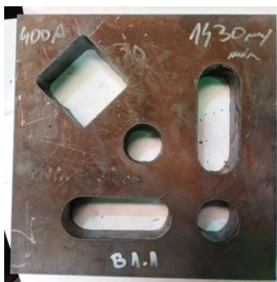
Slika 4.3.56. Uzorak B11.1 debljine 35 mm s podacima o rezanju
