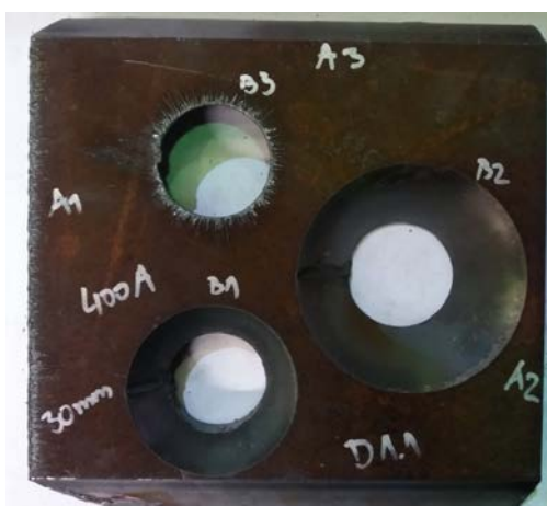
Slika 4.3.72. Uzorak D4.1 debljine 30 mm s podacima o rezanju i oznakama
