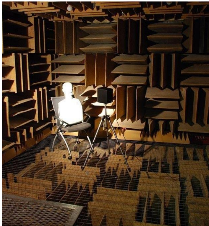
Slika 3.12 Izgled gluhe komore [11]
