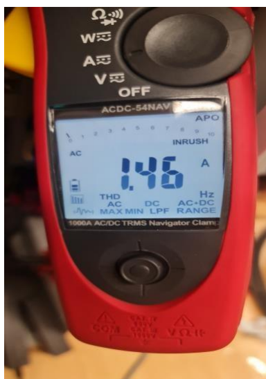
Slika 6.4 – Mjerenje strujnim kliještima kod pokretanja VFD-om
