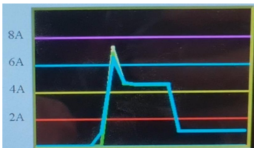
Slika 6.12 – Mjerenje PLC-om kod pokretanja spojem zvijezda-trokut
