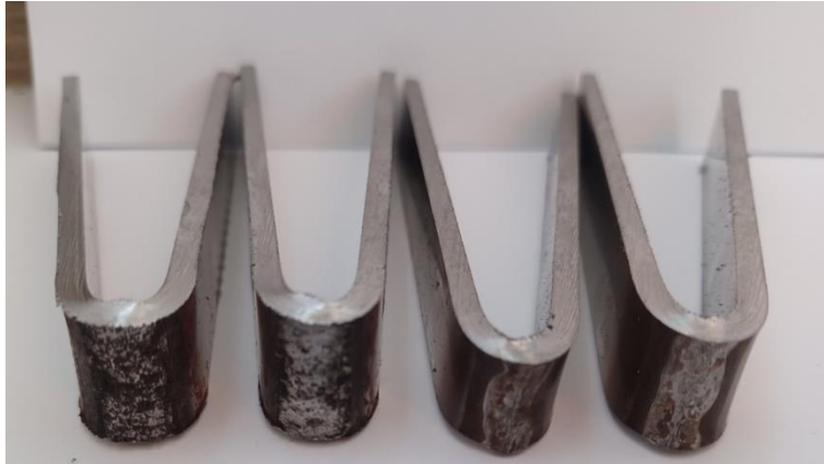
Slika 49. Epruvete iz uzorka 3 nakon ispitivanja savijanjem u 3 točke
