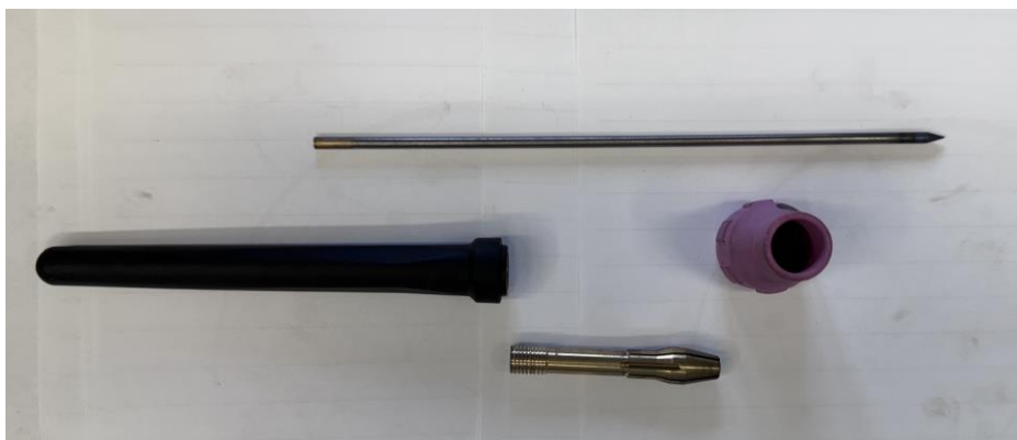
Slika 23. Dijelovi pištolja za zavarivanje (zaštitna kapa, vodilica, elektroda i sapnica)
