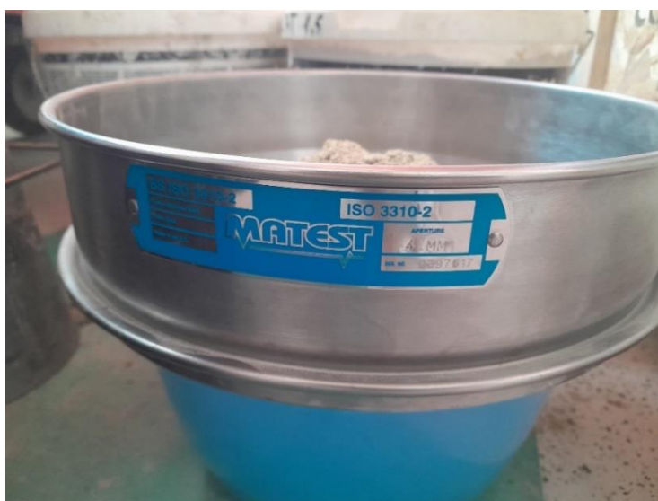
Slika 43. Sito za prosijavanje agregata 4mm
