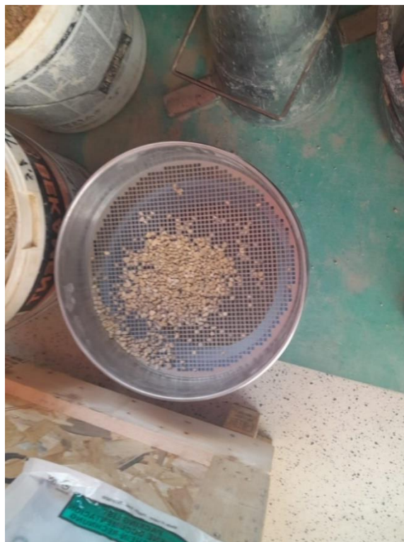
Slika 44. Ostaci agregata ( pijeska ) na situ
