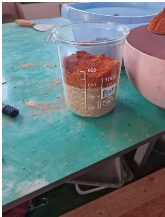
Slika 45. Prosijani agregat ( pijesak i drobljena opeka )
