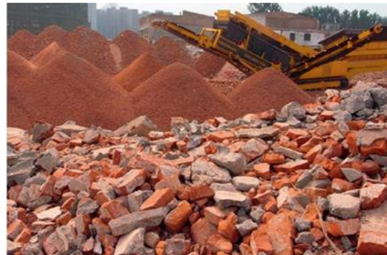
Slika 38. Otpad od glinene opeke, obrada agregata [15]
