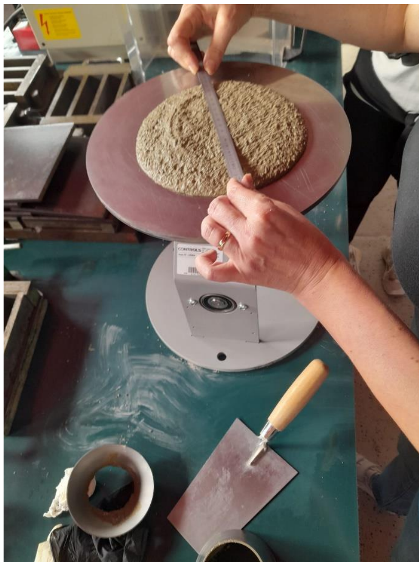
Slika 49. Određivanje konzistencije morta na stoliću za potresanje
