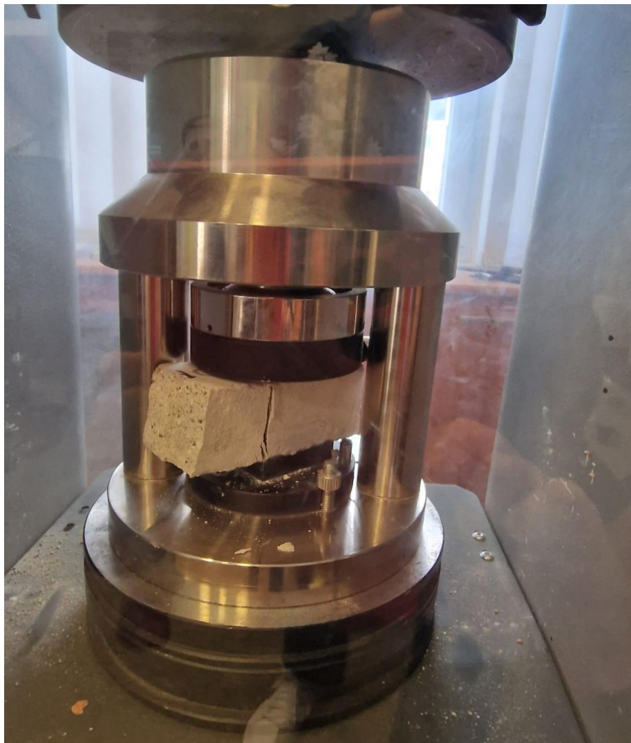
Slika 53. Ispitivanje tlačne čvrstoće
