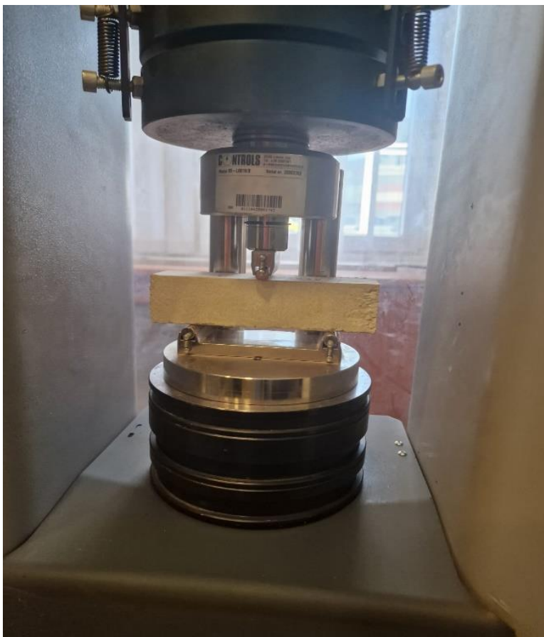
Slika 54. Ispitivanje vlačne čvrstoće
