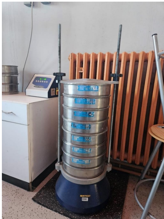
Slika 42. Sita za prosijavanje agregata
