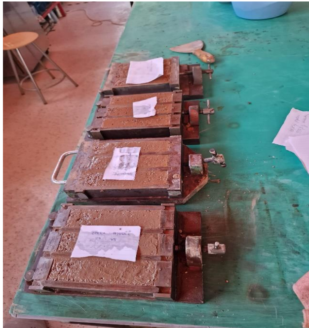
Slika 51. Mješavine morta ugrađene u kalupe
