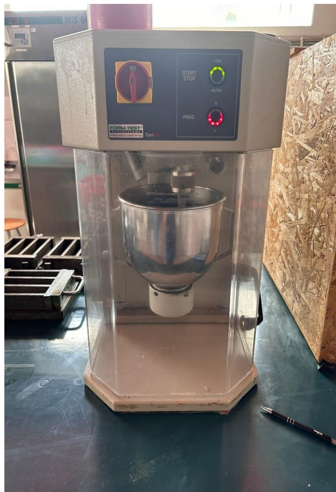
Slika 48. Miješalica za izradu mješavina morta
