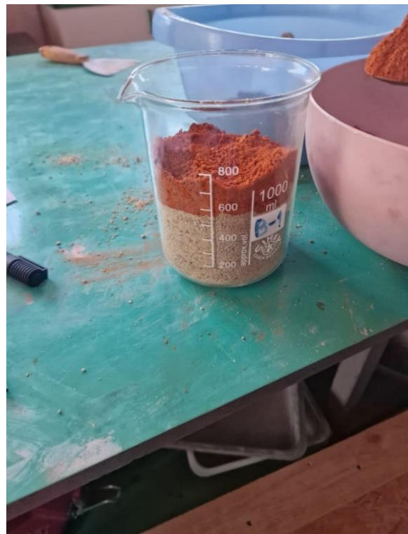
Slika 45. Prosijani agregat ( pijesak i drobljena opeka )
