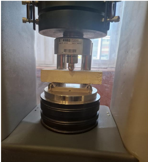
Slika 43. Ispitivanje vlačne čvrstoće
