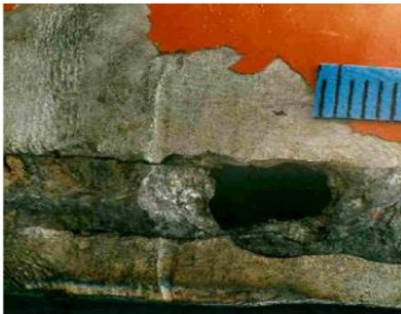
Slika 22. Selektivna korozija - primjer zavarenog spoja Cr - Ni čelika [19]
