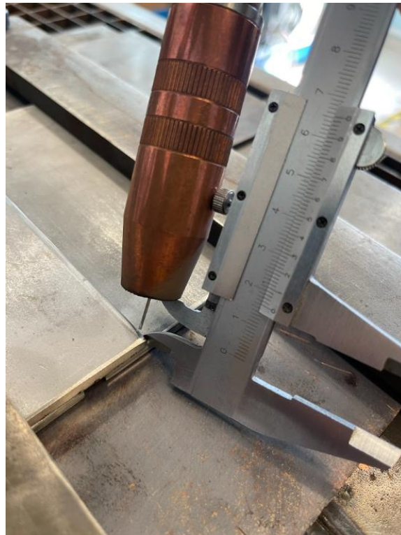
Slika 36. Udaljenost sapnice od radnog komada [28]
