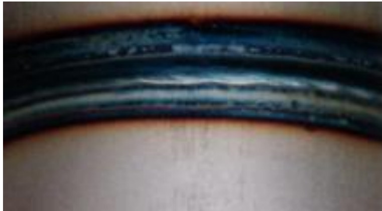
Slika 24. Oksidacija uz zavar [20]
