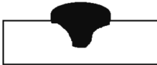
Slika 19. Utjecaj zaštitnog plina argona na geometriju zavora [14]
