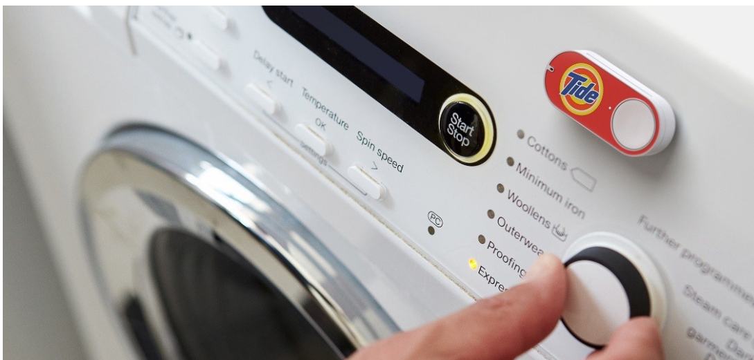
Slika 13: Primjer Amazon Dash gumba koji služi za naručivanje proizvoda (Izvor: [3])
