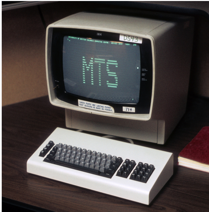
Slika 2: IBM 3270 terminal prikazuje zaslon za prijavu (Izvor: https://rb.gy/3tt6x1 )
