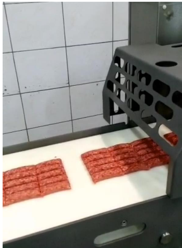
Slika 7.2 Testiranje rada stroja za tri porcije
