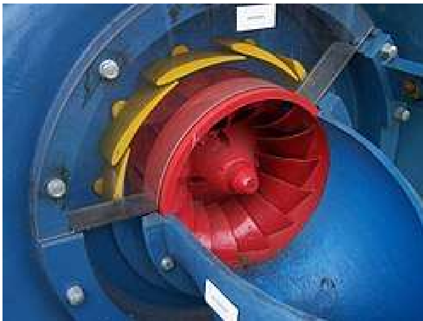
Slika 2.3 Presjek kroz Francisovu turbinu [8]
