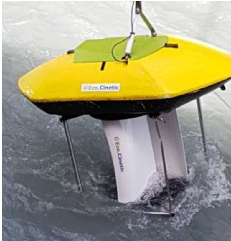
Slika 2.33 EcoCinetic, Savonius rotor na vertikalnoj osi [27]
