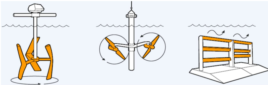
Slika 2.10 Shematski prikaz kinetičkih vodnih turbina [11]
