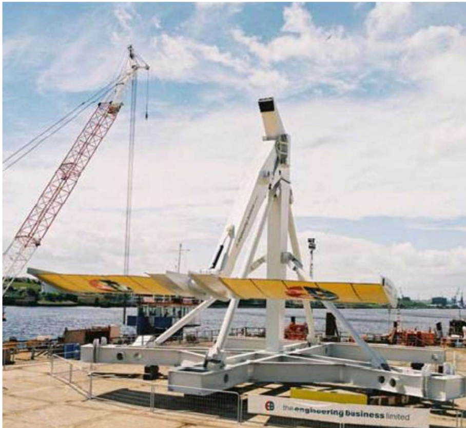
Slika 2.13 Prikaz oscilirajuće turbine („riblja peraja“) [11]
