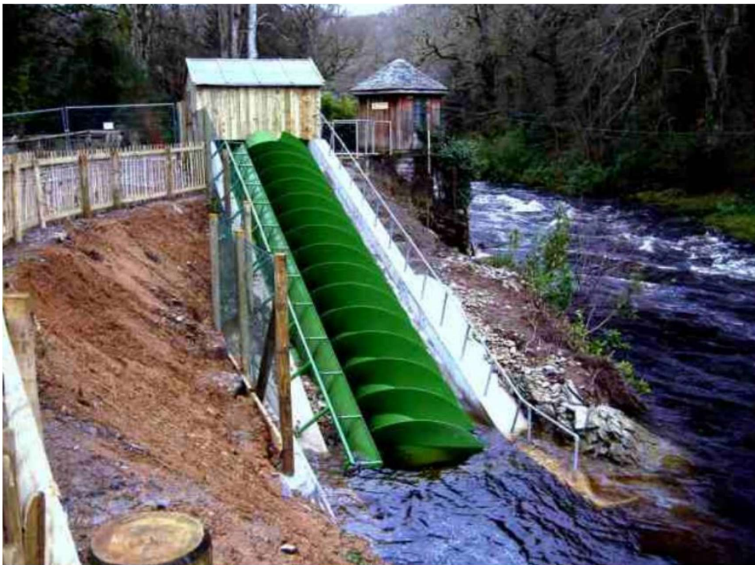
Slika 2.21 Prikaz Arhimedove spirale u svojstvu turbine [11]
