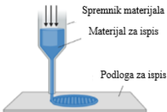
Slika 2.2. Prikaz tehnologije 3D ispisa na bazi ekstruzije [38]
