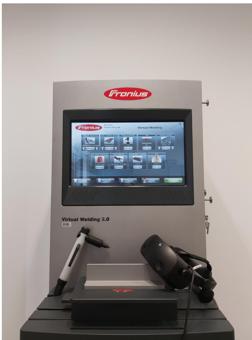
Slika 10. Simulator Fronius Virtual Welding 2.0 sa Sveučilišta Sjever
